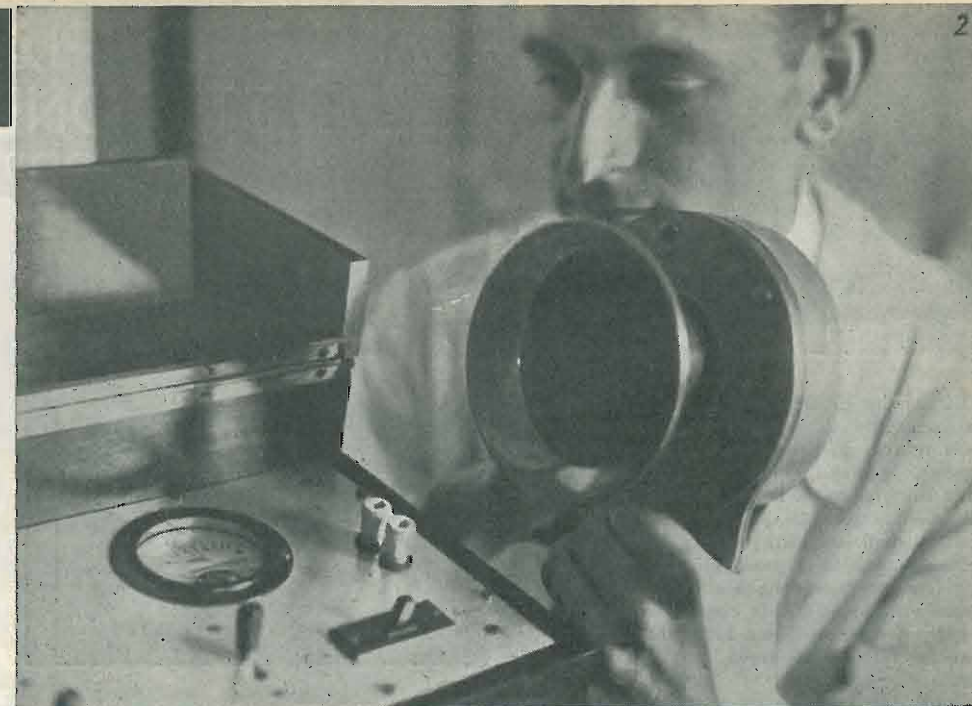
Fig. 1. - Misura dei rumori mediante un microfono. La sonorità si legge direttamente in fono. Installazione nell'Istituto Hertz al Politecnico di Berlino.
