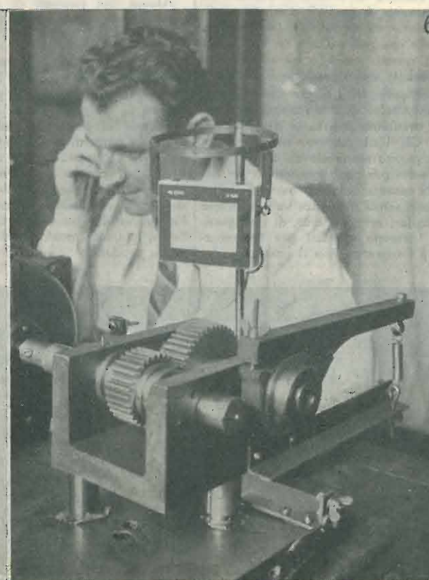
Fig. 4. - Misura della sonorità di un rumore mediante paragone con un tono normale. L'osservatore sente il rumore del motore coll'orecchio
